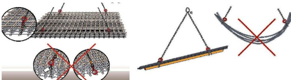
3. La forca può essere utilizzata per il sollevamento in quota di materiale imballato solo se i pallet e gli involuti di materiale sono certificati dal produttore (secondo norme UNI) con diciture chiaramente riportate all'esterno delle confezioni. Gli schemi sottostanti indicano le caratteristiche che devono avere i pallet e gli imballi per utilizzare la forca e le modalità di sollevamento
